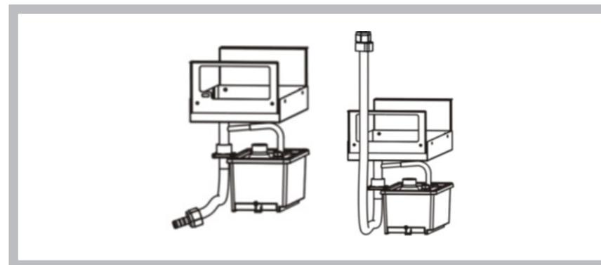
A. Baje la tubería de agua y conéctela a la alcantarilla, asegúrese de que la tubería no esté obstruida y su ubicación sea inferior a la de la articulación, hasta el receptor de agua superior.
