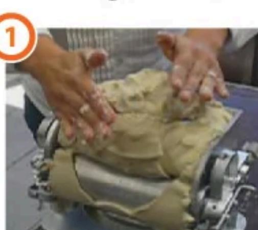
Coloque la masa en la parte superior de la máquina y presione firmemente hacia abajo para compactar la masa.
