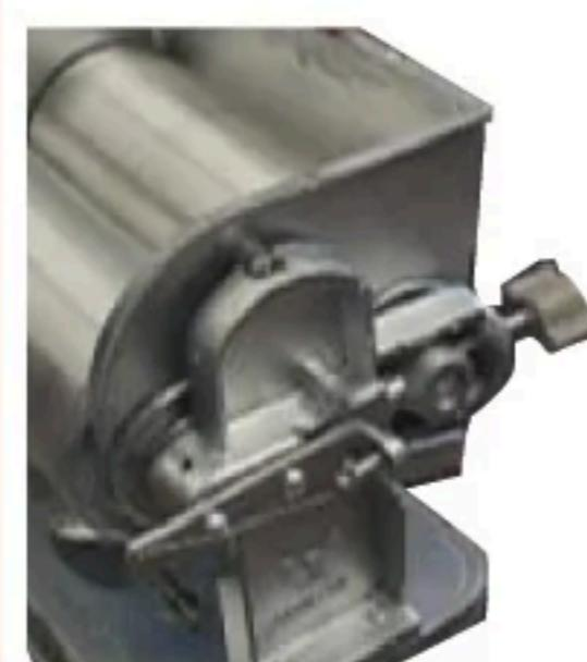
Para regular el grosor de la tortilla debe de girar los 2 tornillos de la parte posterior de la máquina de forma uniforme hasta lograr el grosor deseado.
