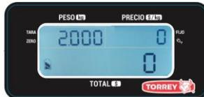
Presione la tecla TARA, el visor/pantalla mostrará ceros y el indicador de TARA y CERO se activarán, ahora sí coloque el material dentro del contenedor puesto sobre la báscula para ser pesado.
