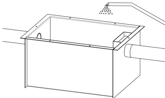
3. Coloque nuevamente la placa antiderrapante, placa desviadora y las mamparas a su posición original y apretar tornillería.
