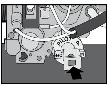
Una vez que el piloto se mantenga encendido sin presionar la perilla de la válvula milivolt, gírela a la posición ON, de no ser así, repita los pasos anteriores.
