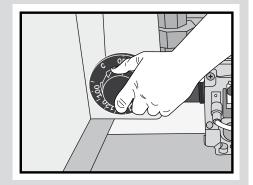
Posteriormente vuelva a girar la perilla de la válvula milivolt, colocandola en la posición **PILOT**.
