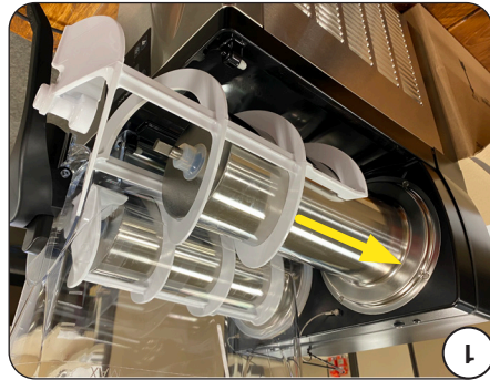
1. Empuje los sinfines hasta el tope sobre el tambor de entrada y girelas para que las aletas planas queden alineadas dentro del sinfín.
